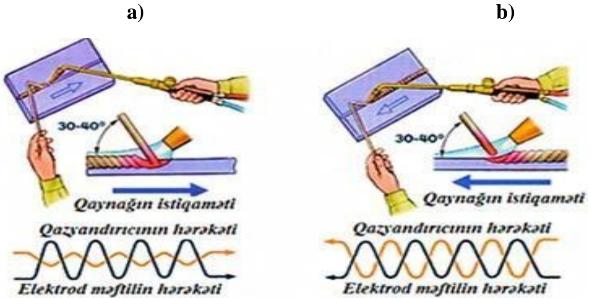
Şəkil 4. Sağ (a) və sol (b) üsullarla qaz qaynağının aparılma texnologiyası
