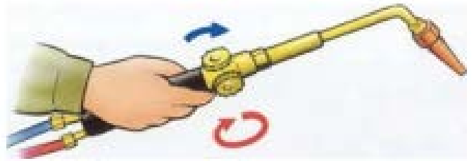
Şəkil 5. Yandırılacaq qaz qarışıqı təzyiqinin nizamlanması
