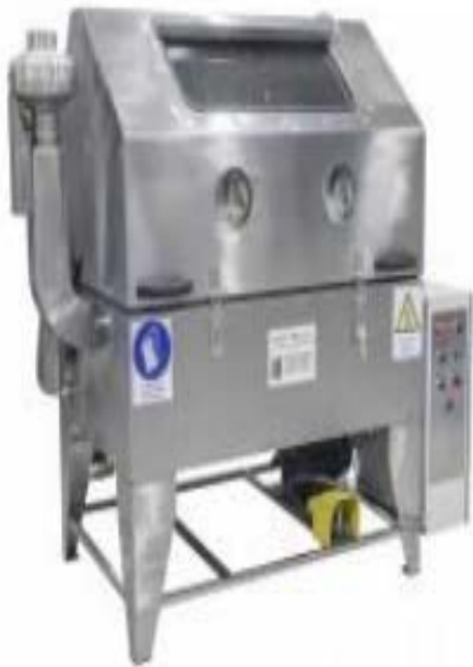
Yığım vahidləri və hissələri təmizləmək və yağsızlaşdırmaq üçün qurğu
