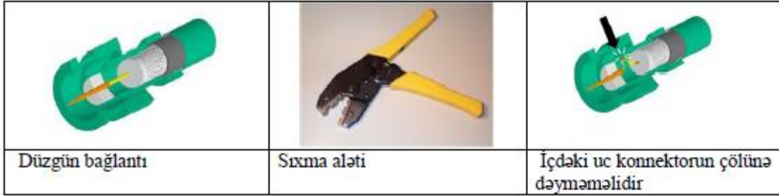
Şəkil 1.14 Koaksial kabelin şəbəkəyə qoşulması
