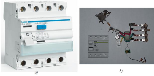
Şək.2. Sızma cərəyanından mühafizə avtomatı (a) və onun sökülmüş vəziyyəti (b).
