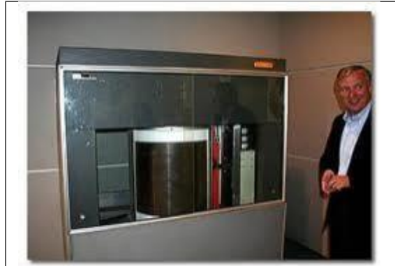
1 ton çəkili ilk RAMAC sərt diski
