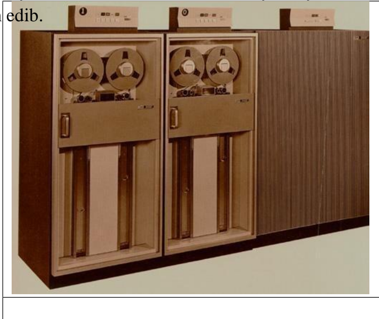
IBM 726-in lent daşıyıcı modulu
