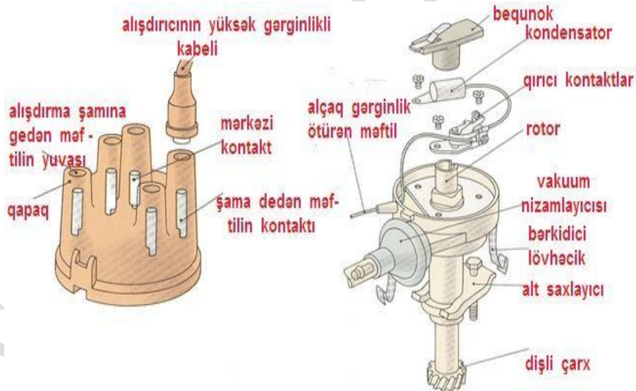
Şəkil 3.3 Qırıcı-paylayıcı
