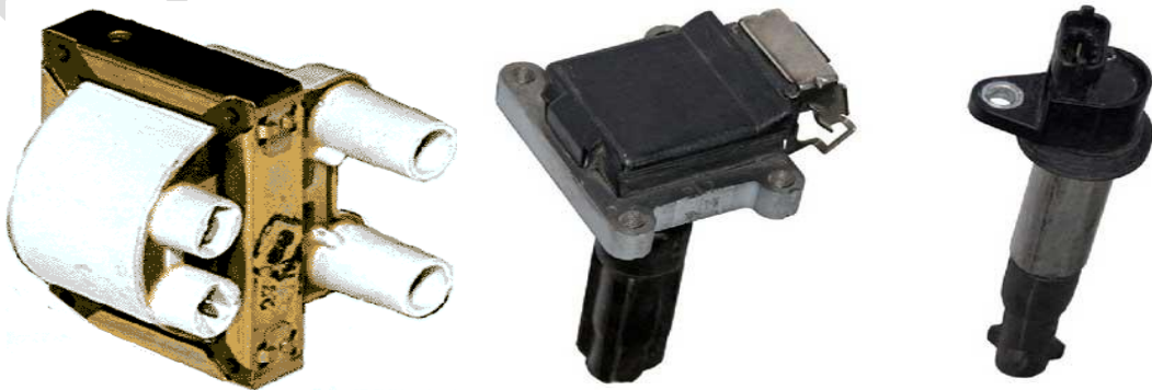
Şək. 11. Mikroprosessorlu idarəetməli alışdırma sistemlərinin alışdırma transformatorları.
