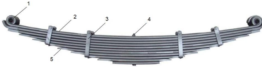
Şəkil 92. Rəssor: 1 – birləşmə başlığı; 2 – əsas vərəq; 3 – xamut; 4 – mərkəzi bolt; 5 – rəssor vərəqi
