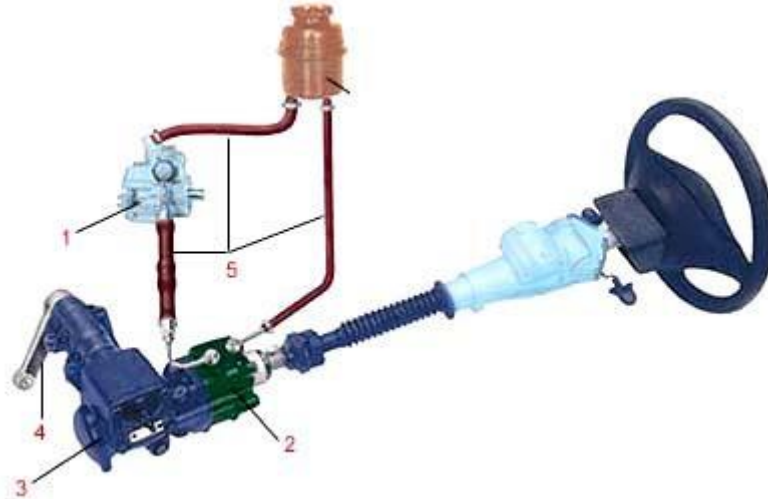
Şəkil 80. Hidravlik gücləndiricili sükan mexanizmi: 1 – nasos; 2 – paylayıcının gövdəsi; 3 – sükan mexanizmi; 4 – sükan soşkası; 5 – birləşdirici şlanqlar; 6 – yağ çəni
