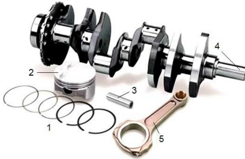
Şəkil 13. Çarxqolu-sürgüqolu mexanizminin tərpənən detalları:
