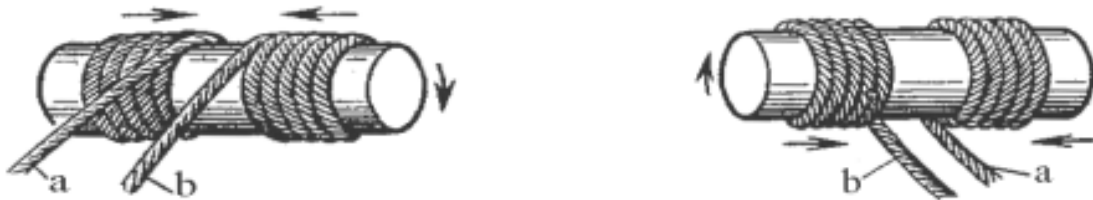
Şəkil 4.5. Hörmələrin istiqamətinə görə kanatların tətbiqi a-sağa dolanan; b-sola dolanan
