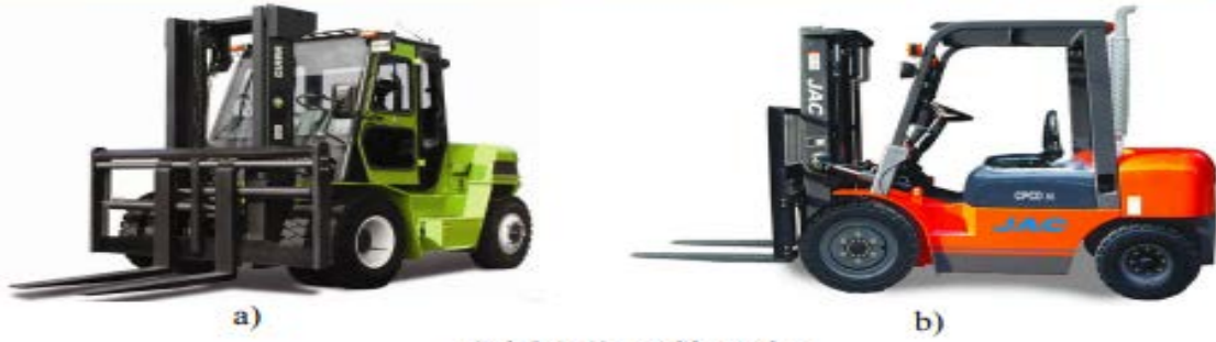
Şəkil 1.69. Yükləyicilər: a) avtoyükləyici ; b) elektroyükləyici
