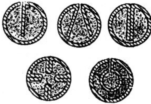
Şəkil 4.3. Dairəvi en kəsikli ovuntulu məftil örtüyünün formaları
