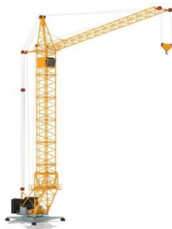
Şəkil 41. Qülləli kran.
