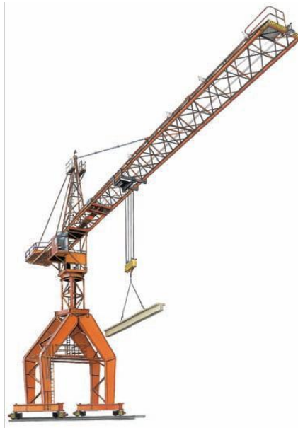
Şəkil 49. Qülləli kran
